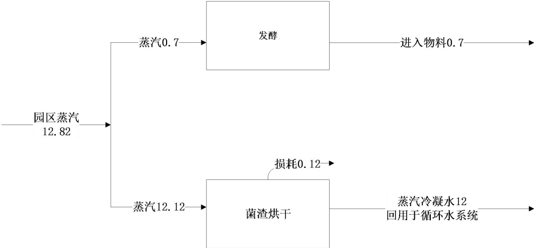
图 2.2-4a 拟建工程总蒸汽平衡图（t/d）
